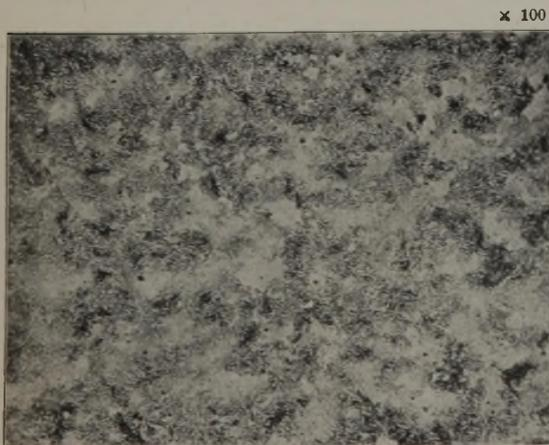
Abbildung 3. Eutektoider Stahl, schieferbrüchig; gegläht bei  $800^\circ$ .
