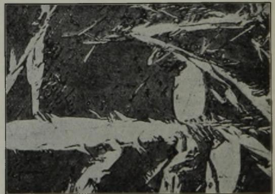
Abbildung 2. Stahl mit 1,57 % C bei 1100° abgeschreckt, nicht angelassen.
