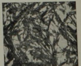
Abbildung 10. Gittertroostit aus Martensitform III nach Anlassen auf 200°.
