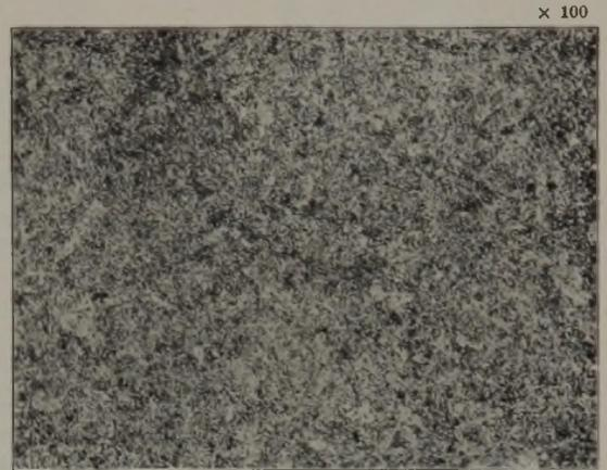
Abbildung 2. Eutektoider Stahl, sauerstoffarm; gegläht bei  $800^\circ$ .
