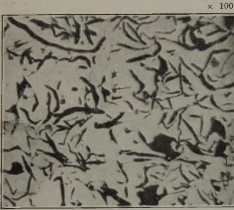
Abbildung 1. Graphitverteilung in hochgekohltem perlitischen Gußeisen.
