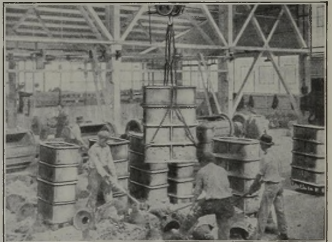
Abbildung 2. Entleerung der Glühgefäße mit Hilfe des Kranes.
