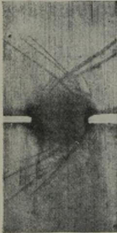
Abbildung 8. Beidseitig gekerbter Flachstab, gedehnt. Aetzung nach Fry.
