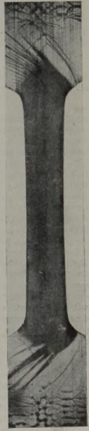
Abbildung 7. Wie Abb. 3. Dehnung 20%, Aetzung nach Fry.
