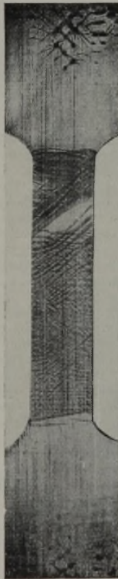
Abbildung 5. Wie Abb. 3. Dehnung 2%, Aetzung nach Fry.
