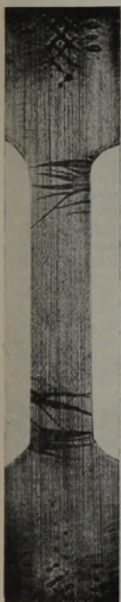
Abbildung 3. Flachzerreißstab, bis zur Streckgrenze beansprucht. Aetzung nach Fry.
