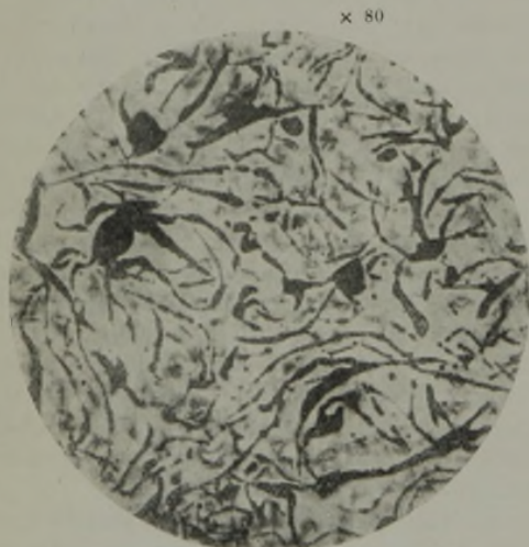
Abbildung 1. Gußeisen mit 1,8% Si in eine auf 1000° vorgewärmte Kokille gegossen.
