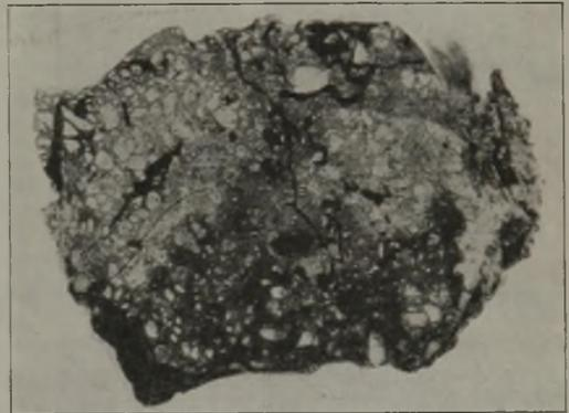
Abbildung 3. Durch Kohlenstaubfeuerung stark angegriffener Silikastein.
