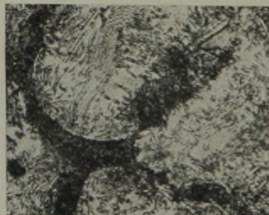
Abbildung 30. Versuch II mit Stahlbriketts (unverrostet). 30 % Brikettzusatz. Aetzung: Natriumpikrat. Aetzung: Pikrinsäure.
