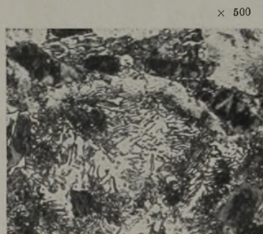
Abbildung 25. Versuch II mit Stahlbriketts (verrostet). 30 % Brikettzusatz. Aetzung: Natriumpikrat. Aetzung: Pikrinsäure.
