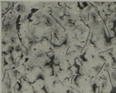
Abbildung 22. Versuch II mit Stahlbriketts (verrostet). 15 % Brikettzusatz. Aetzung: Natriumpikrat. Aetzung: Pikrinsäure.
