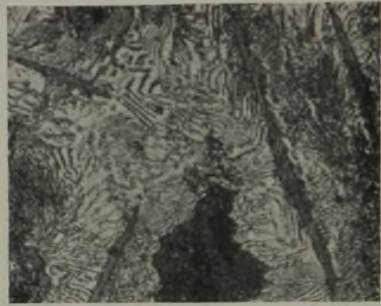
Abbildung 19. Versuch I mit Gußbriketts. 25 % Brikettzusatz. Aetzung: Natriumpikrat. Aetzung: Pikrinsäure.
