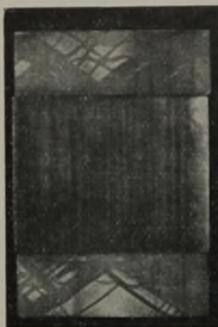
Abbildung 18. Belastung 22 000 kg. Zwischen weichen Druckplatten.
