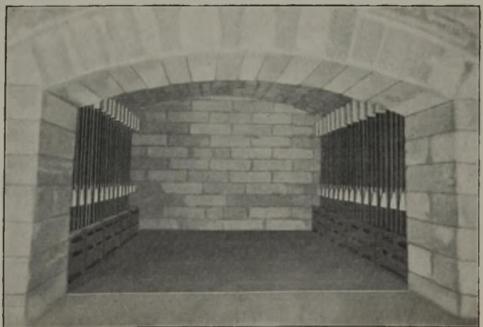
Abbildung 2. Elektroglühöfen mit beheizter Bodenplatte.
