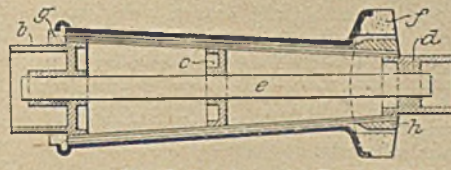
Abb. 2. Anordnung der Kernspindel.
