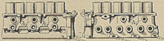
Abbildung 1a. Vorderseite. Abbildung 1b. Rückseite. Abbildung 1a—c. Sechszylinderblock mit angegossenem Zylinderkopf und Radgehäuse.
