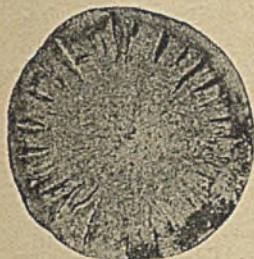
Abbildung 3. Zerreißprobe. Der Kern ist nicht zu erkennen.
