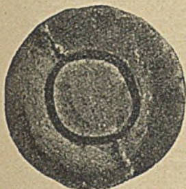
Abbildung 2. Zerreißprobe. Der Kern hat sich gelöst.
