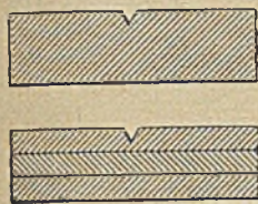
Abbildung 1. Schlagproben aus Walzstäben mit Kern. Oben: Schlagprobe vom Rand. Unten: Schlagprobe vom Kern.
