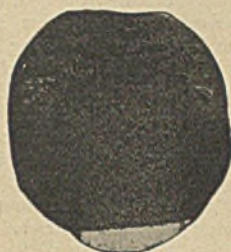
Abbildung 4. Unter der Presse gebrochene Kerbbiegeprobe.
