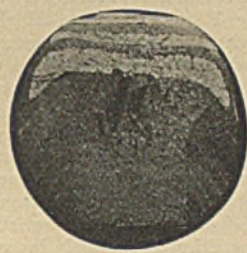
Abbildung 6. Statisch erzeugte Schwingungstreifen auf Kerbbiegeprobe.
