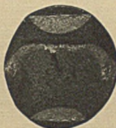
Abbildungen 9 und 10. Durch Mischung von statischen und dynamischen Einwirkungen willkürlich erzeugte Brucherscheinungen auf Kerbbiegeproben.
