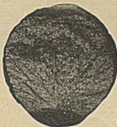
Abbildung 5. Unter dem Fallhammer durchgeschlagene Kerbbiegeprobe.
