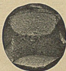
Abbildungen 9 und 10. Durch Mischung von statischen und dynamischen Einwirkungen willkürlich erzeugte Brucherscheinungen auf Kerbbiegeproben.
