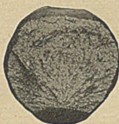
Abbildung 5. Unter dem Fallhammer durchgeschlagene Kerbbiegeprobe.
