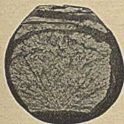
Abbildung 7. Dynamisch erzeugte Schwingungstreifen auf Kerbbiegeprobe.
