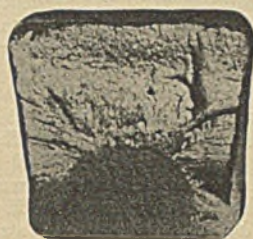
Abbildung 3. Biegeprobe mit zwifältigem Bruchaussehen.
