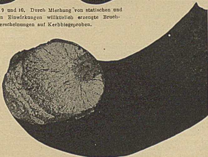
Abbildung 8. Zunächst einseitig gerissenes und dann weiter unter Biegungsbeanspruchung gebrochenes Kettenglied. Bruchfläche mit Schwingungstreifen.
