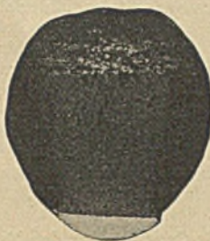
Abbildung 4. Unter der Presse gebrochene Kerbbiegeprobe.
