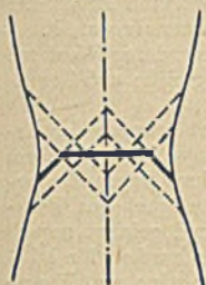
Abbildung 1. Bruchverlauf beim Zerreißversuch, nach Kirsch.
