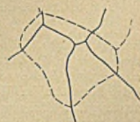
Abb. 5. Diagramm zu Abb. 4. Die gestrichelten Linien geben die Kornbegrenzungen vor dem Erhitzen, die voll ausgezogenen Linien die Kornbegrenzungen nach 6 maligem Erhitzen und Abkühlen an.
