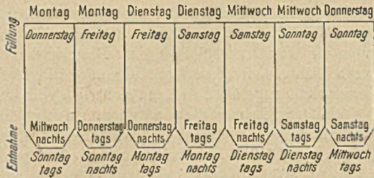
Abbildung 1. Kokskohlenturm mit 7 Abteilungen von je 500 t Fassungsvermögen.
