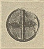
Abbildung 20. Durschlagprobe mit Querbohrung, bei dauernder Drehung geschlagen (vgl. Kerbform 5 der Uebersicht auf S. 1688).
