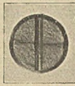
Abbildung 21. Durschlagprobe mit Querbohrung, bei Drehung um 180^\circ in Richtung der Bohrungsachse geschlagen (vgl. Kerbform 7 der Uebersicht auf S. 1688).
