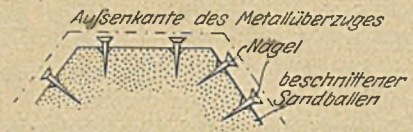
Abbildung 8. Lage der Nägel zum späteren Verankern des Metallüberzugs im Gipsboden.
