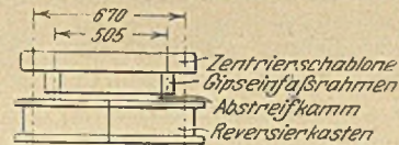
Abbildung 11. Anwendung der Zentrierschablone bei Herstellung kleiner Modellplatten mit großem Werkzeug. Hierdurch wird ermöglicht, mit einem großen Werkzeug auch kleine Modellplatten für verschiedene Stiftenfernungen anzufertigen.
