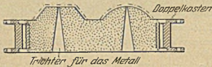
Abbildung 7. Die Form des „Positivs“ nach dem Beschneiden des Sandes. Der hierdurch erzielte Hohlraum dient zur Aufnahme des Metallüberzuges.
