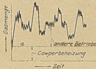
Abb. 1. Einfluß der Gasdruckregler an den Cowpers.
