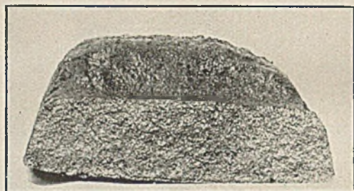
Abbildung 8. Roheisen 2. \times \frac{1}{2} 3,34% C, 4,12% Si, 0,50% Mn, 0,12% P, 0,008% S.
