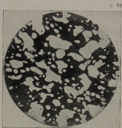
Tremonia Kopf Abbildung 4. Längsschliff.
