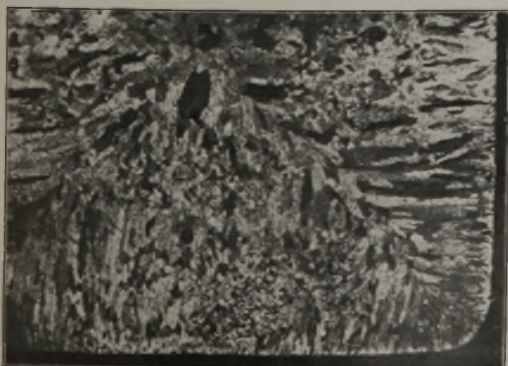
Abbildung 4. Primärkristallite bei hohen Gießtemperaturen und Flüssigkeitsgrad. Vergleichszahl = 60.
