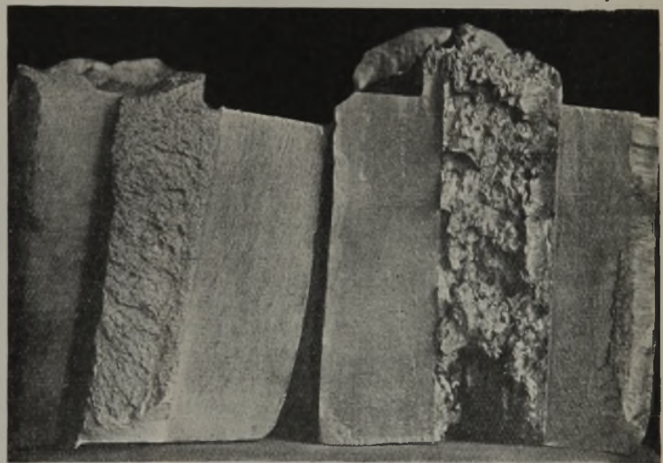
Abbildung 15. Bruchausbildungen bei normalem und Kaltschmieden.
