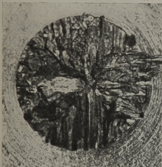
Abbildung 9. Kaltgebrochener Block mit intergranularem Bruch. (Gruppe A.)
