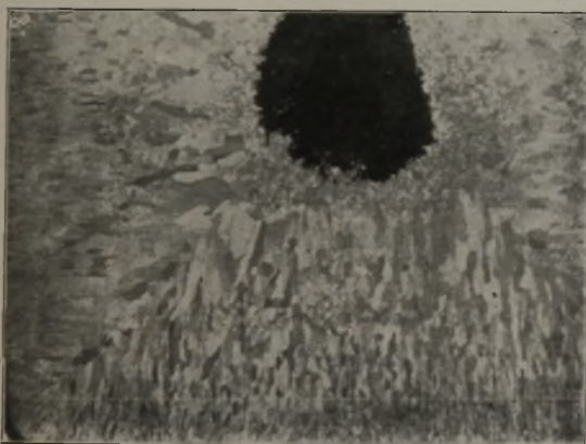
Abbildung 4. Primärkristallite bei hohen Gießtemperaturen und Flüssigkeitsgrad. Vergleichszahl = 60.
