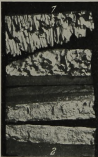
Abbildung 13. Verbesserung des Kaltbruches durch Glühen.
