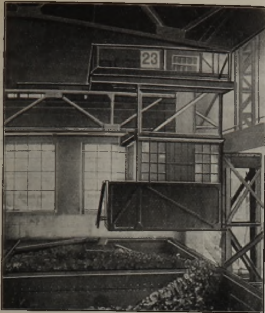
Abbildung 15 und 16. Mitfahrende Laufkatze eines Greiferlaufkranes. Aufstieg vom Führerkorb auf das Katzentriebwerk durch eine Oeffnung in der Kranträgerbrücke. Große Unfallgefahr. Anbringung eines Aufstieges außen an der Katze und Führerkorbkonstruktion leicht möglich.
