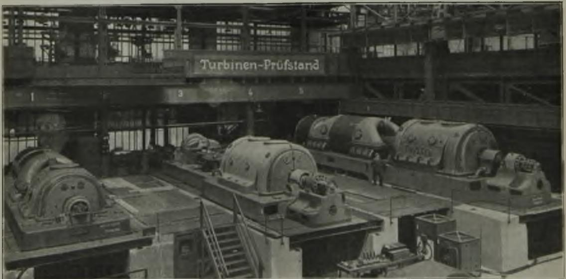
Abb. 1. 32000-kVA-Dampfturbosatz mit 3000 Umdr./min auf dem Prüfstande.
