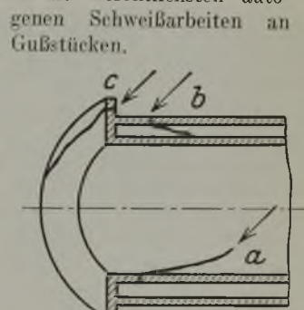
Abbildung 8. Autogene Schweißungen an einem doppelwandigen Zylinder.
