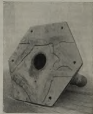
Abbildung 16 c. Ständerplatte nach der Schweißung.
