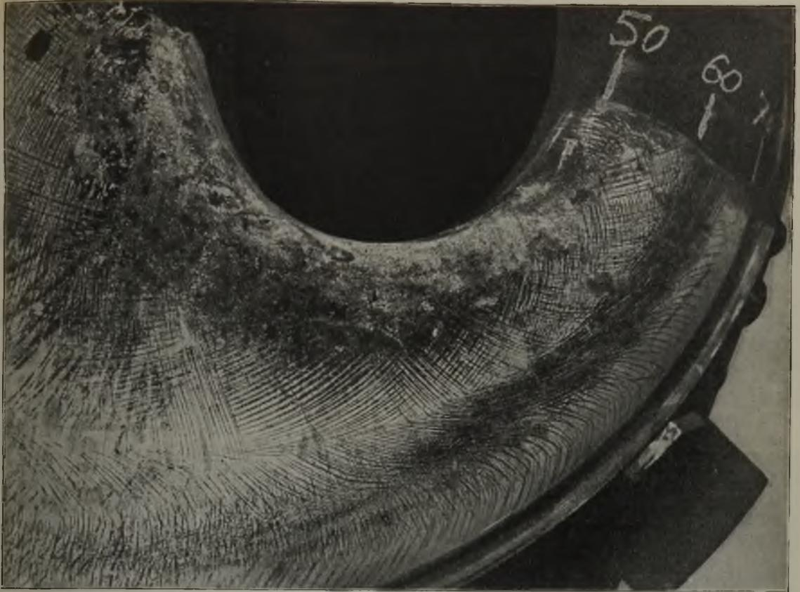
Abbildung 16. Fließerscheinungen an der Bodenoberfläche in der Umgebung eines seitlichen Mannlochs.
