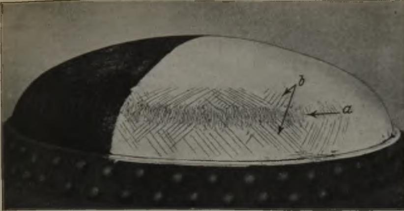
Abbildung 9. Fließerscheinungen an einem tiefgewölbten Vollboden von 1300 mm  $\Phi$  und 20 mm Wandstärke bei einem Innendruck von 63 at.
