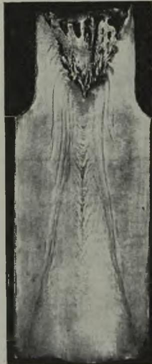
Abbildung 1. Querschnitt eines Blockes mit ausgeprägter Zonenbildung.
