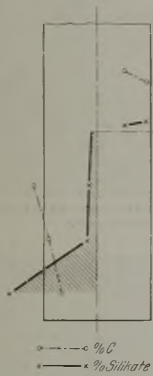
Abbildung 7. Verteilung der Silikate in einem 50-t-Block nach Dickenson.
