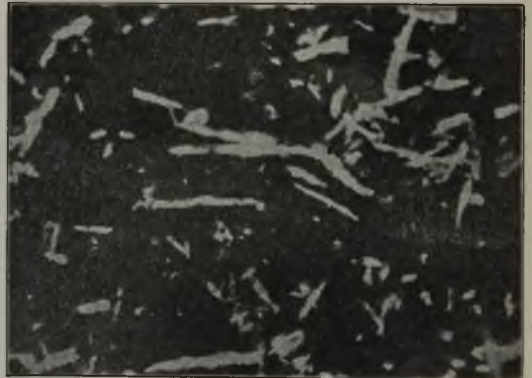
Abbildung 2. Nach dem gleichen Verfahren aus einem Schmiedeblock herausgelöste Schlacke.
