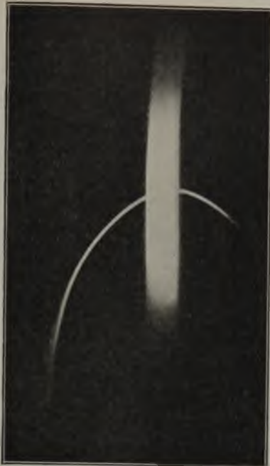
Abbildung 3. Das Wolframband im Pyrometersichtsfeld.
