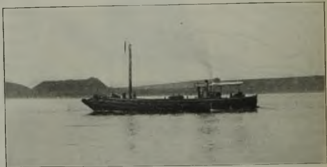
Abbildung 4. Schiff zur Beförderung von flüssigem Roheisen.
