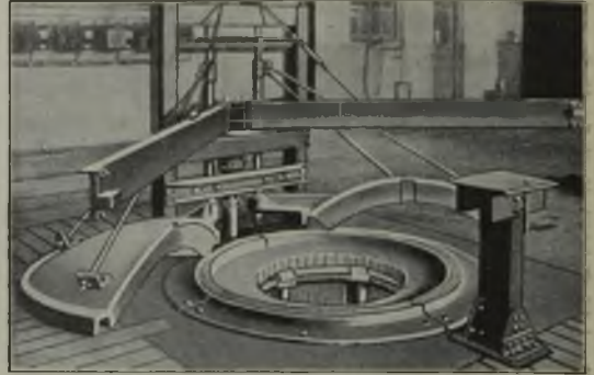
Abbildung 19. Tiefgrube für Blöcke von 3,6 t.
