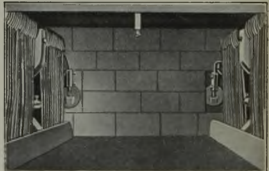
Abbildung 20. Ofenraum zum Einsetzen von Blechen usw.
