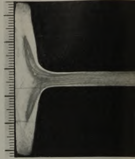
Abbildung 9. Seigerungszone des fertigen Tragers.
