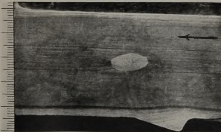
Abbildung 20. Schnitt durch die Mitte der Schraube IV.
