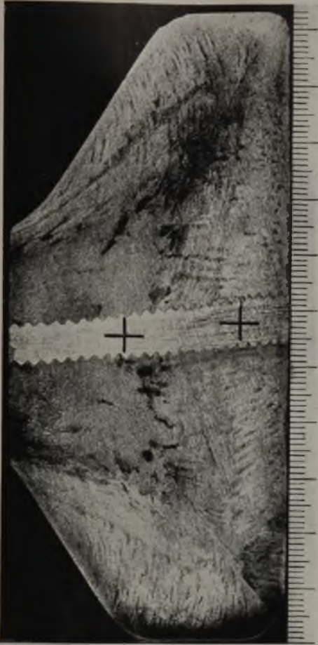
Abbildung 19. Schnitt der wagerechten Schraube IV durch die Achse des Anstiches.
