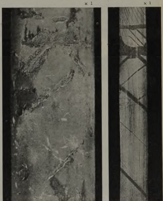
Abbildung 2. Oberfläche des Rohres angeschliffen und nach Fry geätzt. (Spiegelbildlich.)
