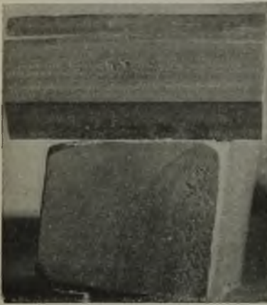
Abbildung 1. Langschliffe durch Stäbe mit weichem Mittelstreifen.
