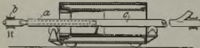
Abbildung 11. Mehrfach gestützte Gießrinne der Arensröhren-A.-G. in Hamburg. D. R. P. Kl. 31 c, Gr. 18, Nr. 418340.
