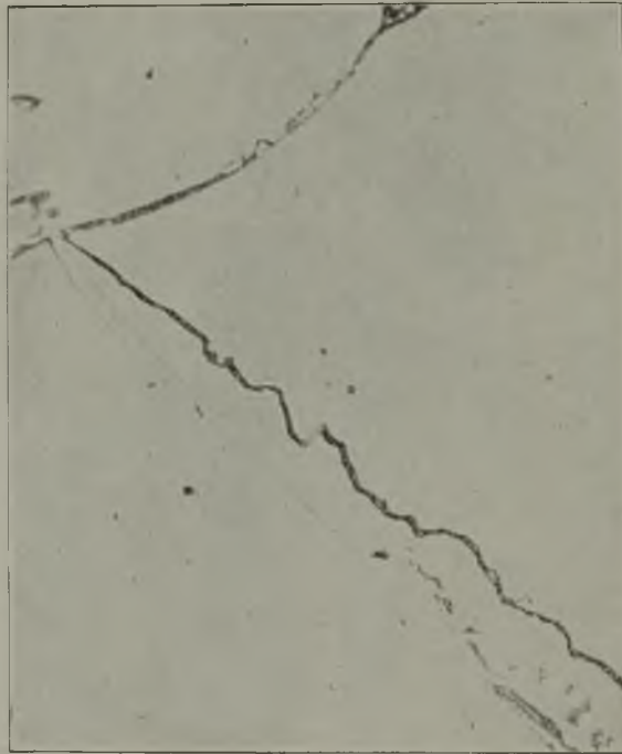
Abbildung 7. Gleitlinien verformten Elektrolyteisens nach dem Anlassen.
