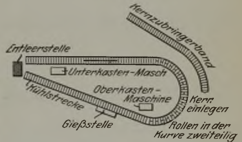
Abbildung 7. Formband für Hohlgußstücke mit vielen getrockneten Kernen.
