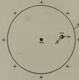
Abb. 3. Einwirkung der elektrischen Felder auf ein Staubteilchen.
