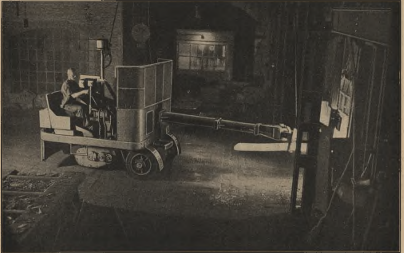
DDS-Auto-Chargiermaschine in einem Bandeisenwalzwerk
