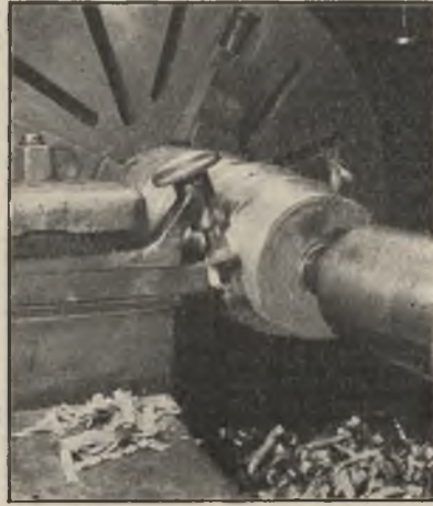
Bild 3. Drehen mit Spänebrecher nach Bild 1.
