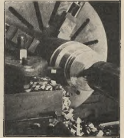
Bild 4. Vereinfachter Spänebrecher für gleichbleibende Verhältnisse.
