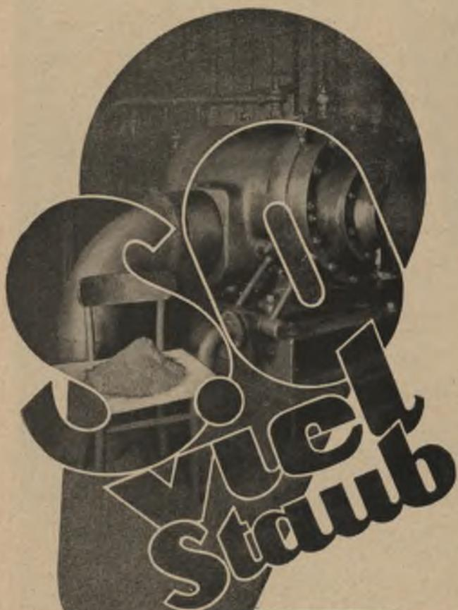
enthält im Mittel die Luft, die an einem einzigen Tage von einem Rotationskompressor mit 3600 cbm Stundenleistung angesaugt wird. Würde das Filter den Staub nicht zurückhalten, so gelangte er in den Kompressorzylinder und führte dort zu vorzeitigem Verschleiß. Sie tun deshalb gut daran, wenn Sie das Filter Ihres DEMAG-Kompressors laufend reinigen und pflegen, damit es immer voll wirksam bleibt.
