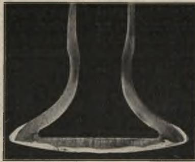
Bild 6. Hohlkeller eines Auslaßventils mit ein- und aufgeschweißtem Boden aus einem russischen Flugmotor AM 35 A. (× rd. 0,75.)
