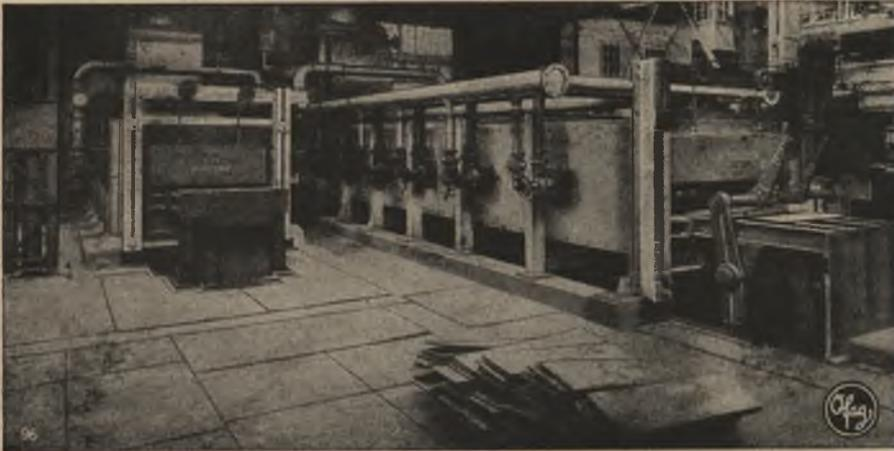
Kontinuierlich arbeitender Platinenwärmofen mit Hubbalkenherd und Auswurfvorrichtung
