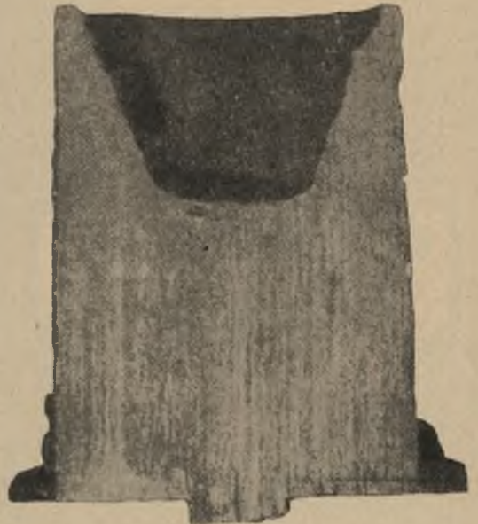
Mit Bruinella „Apece B“ behandelter Kopf eines im Gespann gegossenen 1-t-Blocks.
