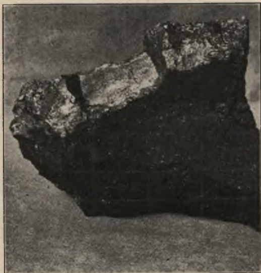
Bild 10. Stark angewachsener Magnesitstein.
