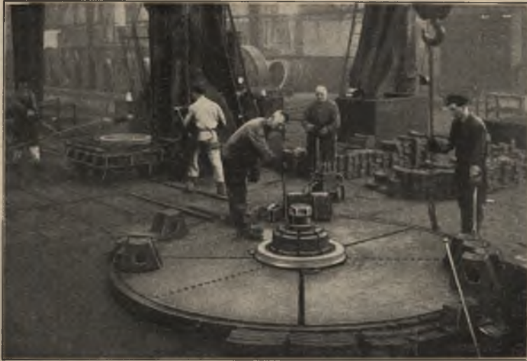
Bild 21. Zentrierpresse für Radreifen.
