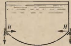
Abb. 69. Älteste Form der Stahl-Behälter
