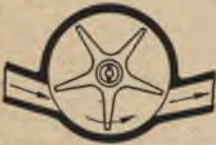
Abb 92. Schematische Darstellung der Arbeitsweise eines Einstrahl-Flügelradzählers
