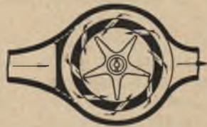
Abb. 93. Schematische Darstellung der Arbeitsweise eines Mehrstrahl-Flügelradzählers
