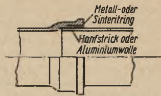
a) Glatte Muffe mit Dichtung
