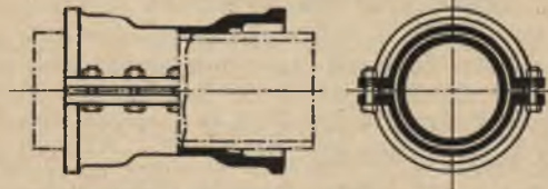
d) Geteilte Muffe. Die Muffe wird fast nur für Arbeiten bei Rohrbrüchen verwendet. Um die Schwanzenden der zu verbindenden Rohre wird die Muffe gelegt und dann durch Schrauben befestigt
