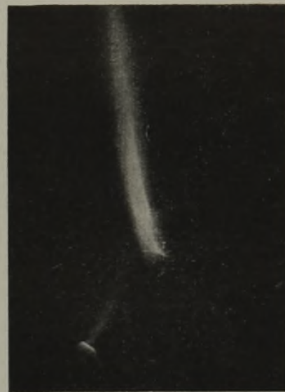
Abb. 2. Beck-Bogen (Hochstromkohlebogen mit Cerfluorid im Docht) mäßiger Verdampfungsgeschwindigkeit (Blasgeschwindigkeit etwa 10 m/s) mit voll ausgebildeter Säulenkontraktion. Positivkohle 16 mm Dmr., 180 A.
