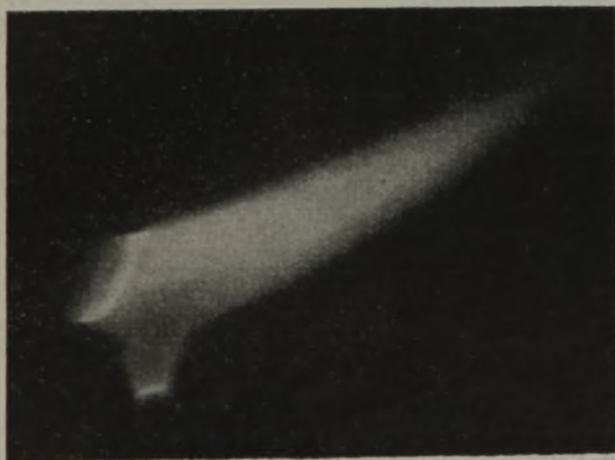
Abb. 1. Homogenkohle-Hochstrombogen hoher Verdampfungsgeschwindigkeit (Blasgeschwindigkeit etwa 50 m/s) mit Andeutung beginnender Säulenkontraktion. Positivkohle 7 mm Dmr., Stromstärke 80 A.
