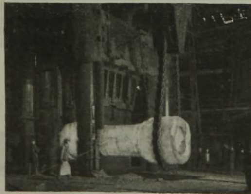
Abb. 2. Großer Hohlkörper unter der Schmiedepresse.
