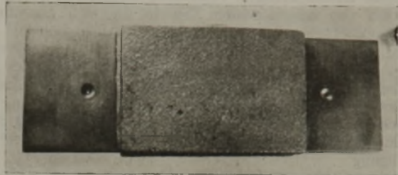
Abb. 3. Prüfstück zur Feststellung der gegenseitigen Spannungen zwischen Eisen und Fe-Si-Platte nach Verlöten.
