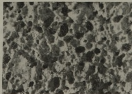
Abb. 11. Porenbeton (Wasserstoffperoxyd-Verfahren). Vergr. 5:1.
