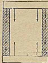
Abb. 13. Stauchung der Schale durch den Kern und die Stirnflächen.
