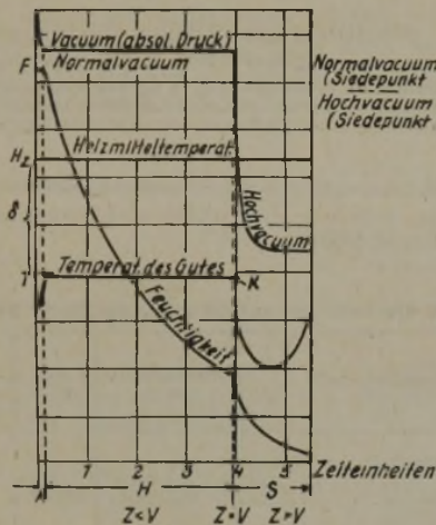
Abb. 8. Trocknungsverlauf mit abgekürzter Schlußtrochnung durch Hochvakuum.
