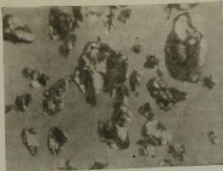
Abb. 3. Eisen-Pulver, hergestellt durch Mahlen von Draht v = 45 .
