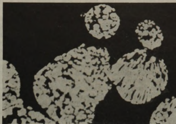
Abb. 10. Kupfer-Blei-Komplexpulver mit 40% Pb. v = 600
