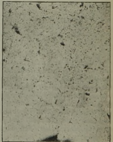
Abbildung 6. Probe aus einem stumpf geschweißten Rohr.
