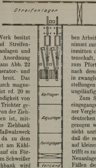
Abbildung 22. Stumpfschweiß- anlage der Youngstown Sheet & Tube Co. (Reiseskizze.)
