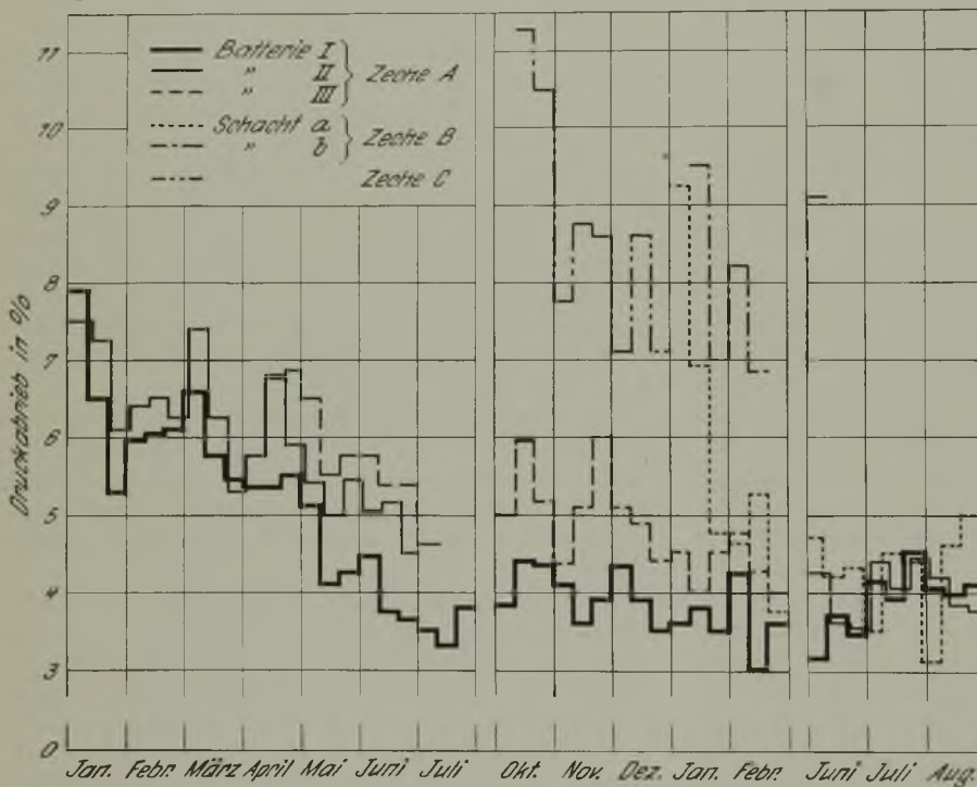
Abbildung 2. Druckabrieb verschiedener Koksorten. (Durchschnitt vom Monatsdrittel, Ergebnis von 4500 Proben.)
