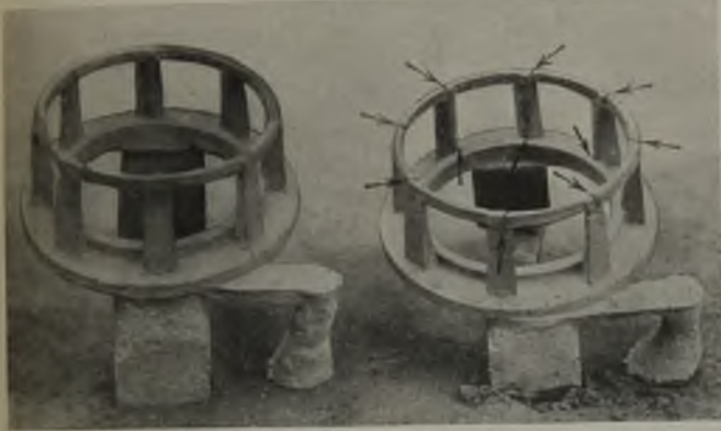
Abbildung 12. Zahnring, in fester und nachgiebiger Form gegossen aus basischem Stahl folgender Zusammensetzung: 0,33 % C, 0,23 % Si, 0,72 % Mn, 0,075 % P, 0,050 % S.
