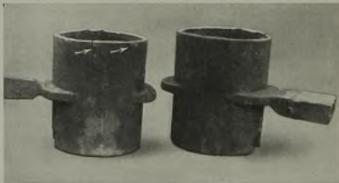
Abbildung 11. Zylinder, in fester und nachgiebiger Form gegossen aus saurem Stahl folgender Zusammensetzung:
