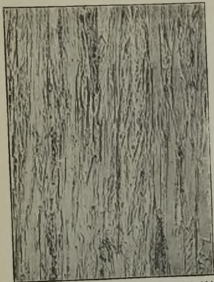
Abbildung 12. Längsschnitt vom Walzstich 10 b zeigt außerordentlich langgestreckte Ferritkristallkörner.
