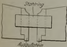
Abbildung 1. Patentierter Ausguß mit Stahlring zur Wärmeableitung.
